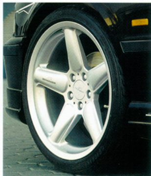
AC Schnitzer Leichtmetallfelgen Typ II, silber in den Größen 8,0J x 16", 8,5J x 17", 8,5J x 18", 10J x 18", 8,5J x 19" und 9,5J x 19".
